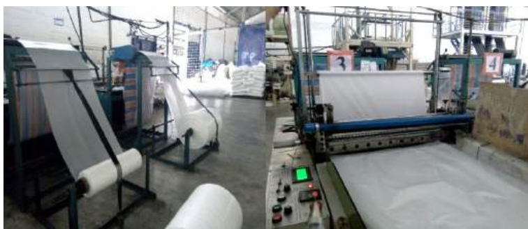
Gambar 1. Mesin Cutting dan Sealing A pada Proses Produksi Inner Karung Urea
