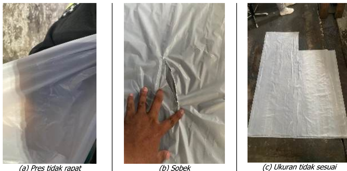
Gambar 2, 3, dan 4. Jenis Cacat Produk Inner Karung Urea : (a) Pres Tidak Rapat, (b) Sobek, (c) Ukuran Tidak Sesuai
