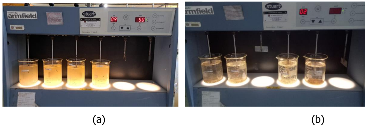
Gambar 3. Proses koagulasi menggunakan PAC (a) dan proses koagulasi menggunakan tawas (b)
