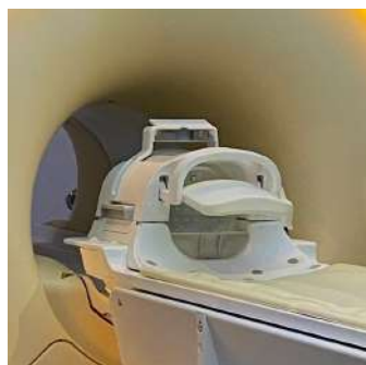
Gambar 2. Water phantom yang sudah terpasang head Coil
